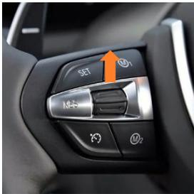
**Wippe nach oben:** Auspuffklappen werden geöffnet und über den gesamten Drehzahlbereich offen gehalten
