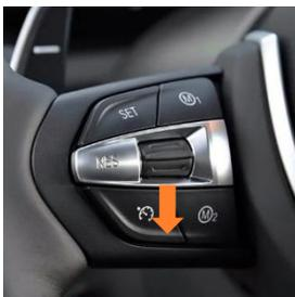
**Wippe nach unten:** Auspuffklappen werden geschlossen gehalten bis zu einer vordefinierten Drehzahl welche über eine Konfigurationssoftware eingestellt werden kann
