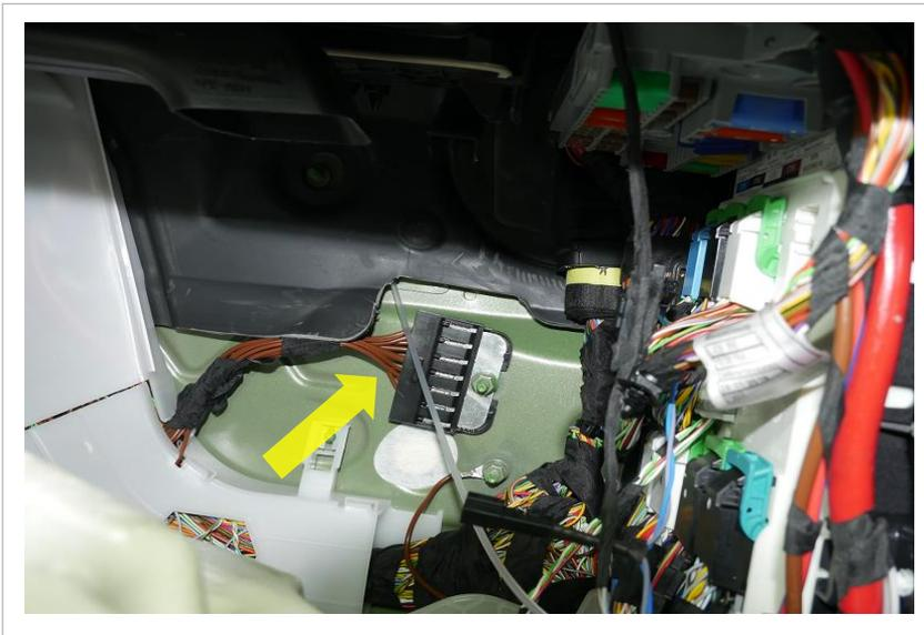
Masse Kl.31 im Fußraum rechts unter dem Teppich an Kammverbinder anschließen.
